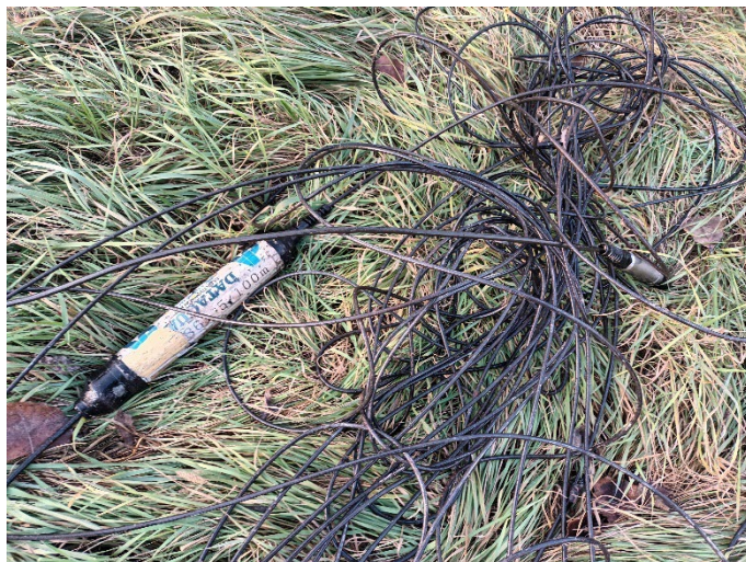
14. ábra; A Tatabánya Tb-8-as kútból kimentett vízszintmérő
