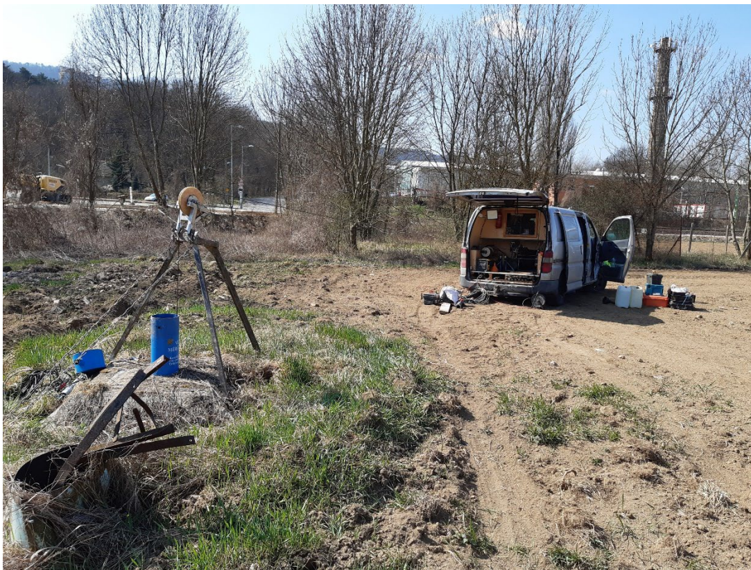
5. ábra; Kútvizsgálati mérés az Óbuda-2 kúton
