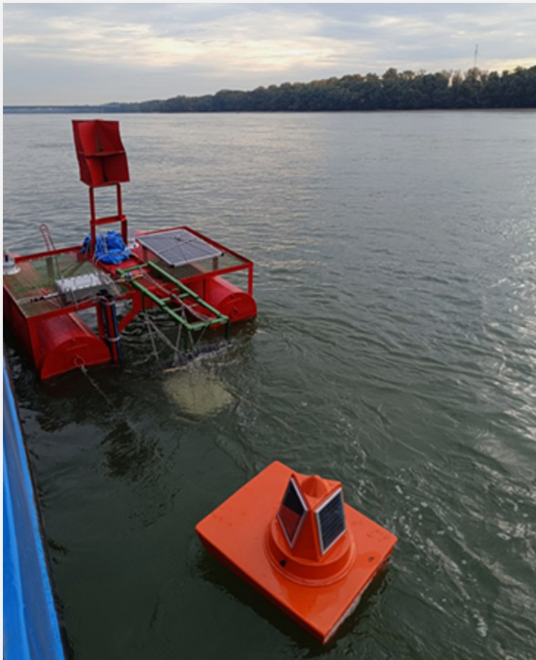
ÉLESBEN, A DUNA SODORVONALÁBAN (JDS5-22) TELEPÍTETT FOLYAMATOS LEBEGŐANYAG MINTAVEVŐ PLATFORM
