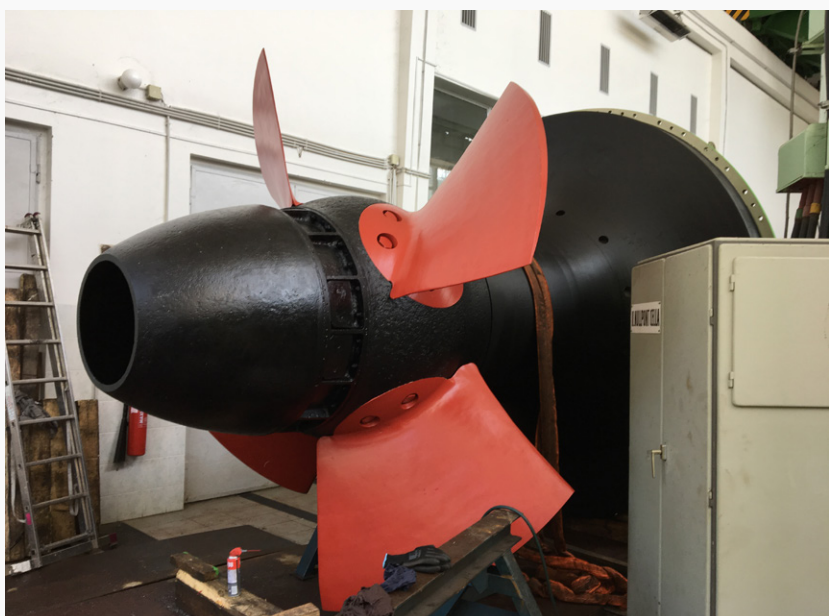
KVASSAY VÍZERŐTELEP VÍZSZINTES TENGELYŰ KAPLAN TURBINA REKONSTRUKCIÓ ELŐTT ÉS UTÁN
