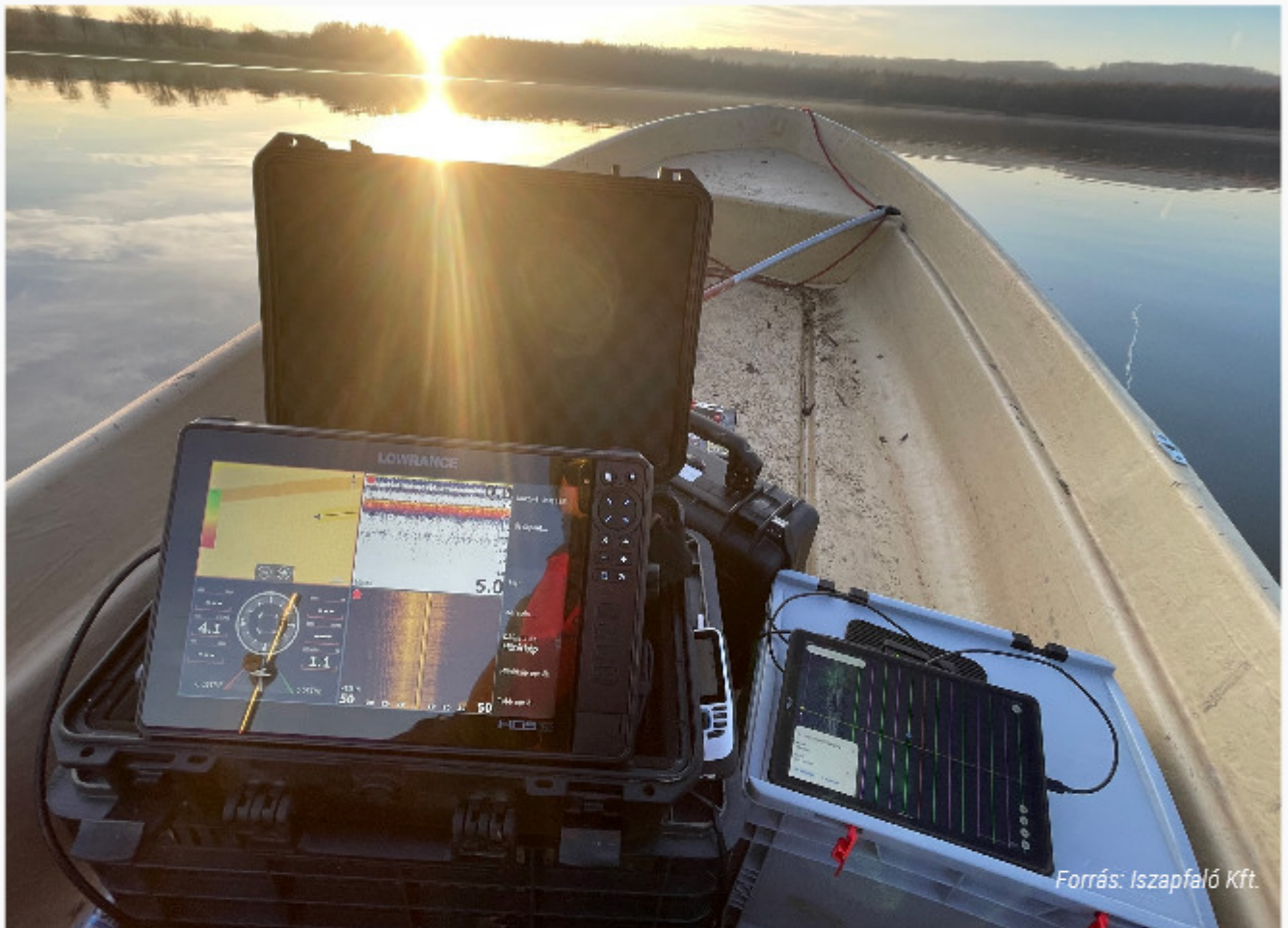
1.KÉP: ULTRAHANGOS MEDERFELMÉRÉS
