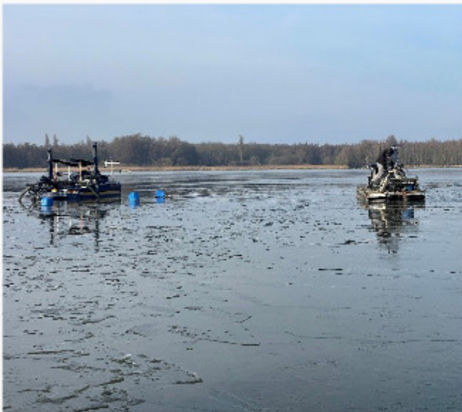
4. KÉP: BERKY PRINCE KOTRÓGÉP (BALRA) ÉS TRUXOR MULTIFUNKCIÓS KÉTÉLTŰ MUNKAGÉP (JOBBRA)
