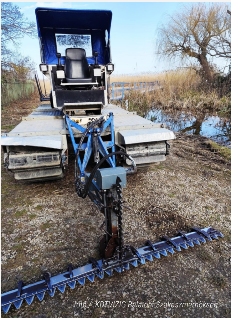
1. KÉP: TRUXOR ÚSZÓ MUNKAGÉP HIDRAULIKUSAN ÁLLÍTHATÓ VÁGÓFELÜLETTEL
