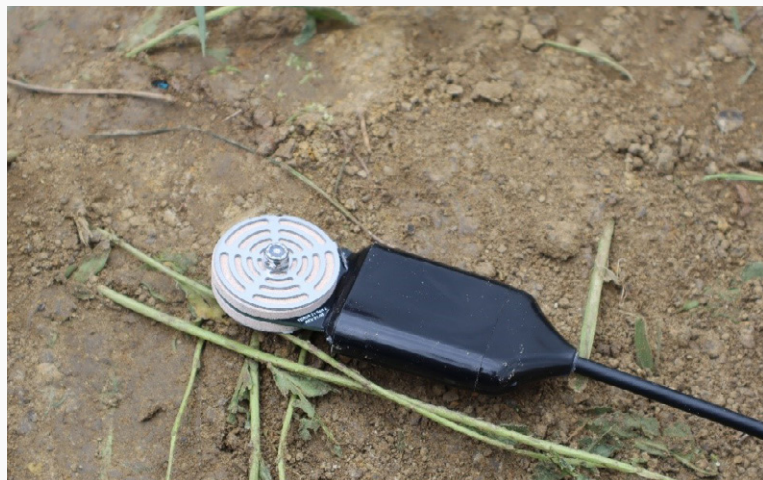
2. A ÉS B KÉP: TALAJNEDVESSÉG-SZENZOR (TEROS 11) TELEPÍTŐVILLÁN ÉS TENZIOMÉTER (TEROS 21)
